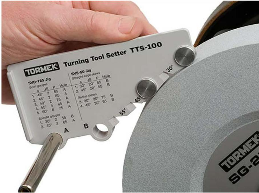
Reproduit la forme du biseau des gouges et planes en utilisant les dispositifs SVD-185 (FG 381565) et SVS-50 (FG 381566).
