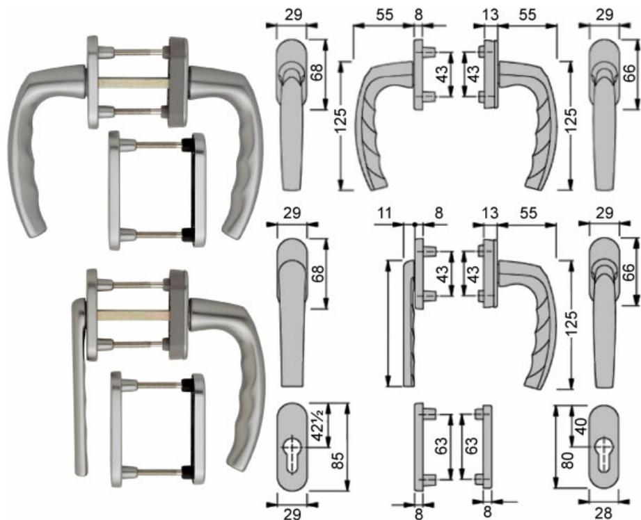
Poignées en aluminium coulé prémontées en paire avec vis et carré pour épaisseur de 68 à 73 mm. Entrées de cylindre avec vis adaptées.
