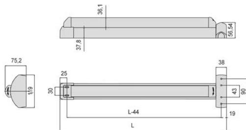
**Remarque :** la largeur de la barre doit au moins représenter 60% de la largeur d'ouverture de l'issue de secours.
