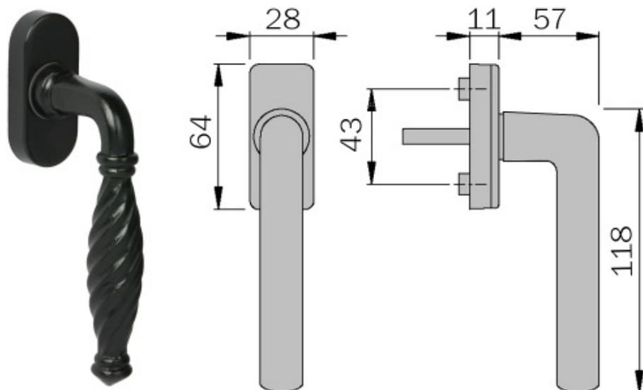
Poignée de châssis rustique en fer noir sur embase en matière synthétique assortie comportant une coiffe coordonnée. Carré de 40 mm recoupable.
