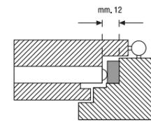
La plinthe 1700 Pressure encastrée dans porte avec règle de 40/50 mm.
