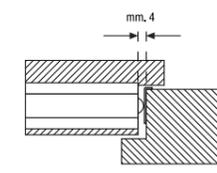
La plinthe 1800 Pressure montée sur porte à mortaise plus profond.
