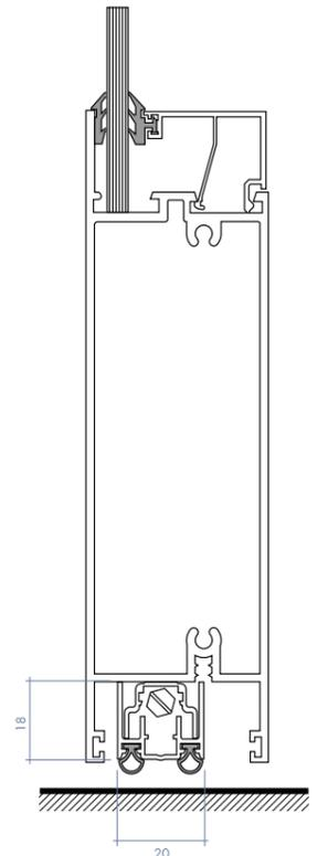
La plinthe 270 dans une application typique pour portes en aluminium.
