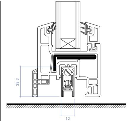
La section de 12 mm. de la plinthe 1770 Pressure permet l'application dans la chambre européenne du profil.
