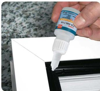
Collages APTK/EPDM dans la construction des fenêtres
