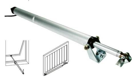
Encombrement réduit : diamètre 34 mm. Développé pour être installé aussi dans le profil du châssis. Transmission du mouvement par tige rigide. Particulièrement adapté pour actionner les lames pare-soleil. Haute protection contre les agents atmosphériques (IP 65). Possibilité de fixation antérieure et postérieure.
