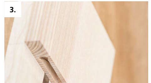
3. Aligner l'étagère comme butée en position décalée à l'aide de la plaque auxiliaire de 2 mm
