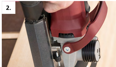
2. Fraisage dans l'arête avec la plaque auxiliaire de 2 mm (profondeur de fraisage : 12 mm)
