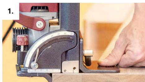
1. Fraisez la rainure P-System avec le réglage P-14
