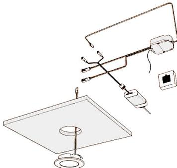
Permet d'allumer et d'éteindre la lumière sans fil et de varier la tension en continu, il est ainsi possible de régler l'intensité lumineuse et de créer une ambiance individuelle. Le gradateur peut être commuté sur une distance maximale de 20 mètres à l'aide de l'émetteur à 2 canaux fourni ou de la commande SmartDrive. La commande de gradation se compose d'un récepteur sans fil et d'un émetteur sans fil.
