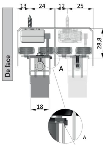
L'activateur doit être placé sur le profil traverse supérieur de la porte
