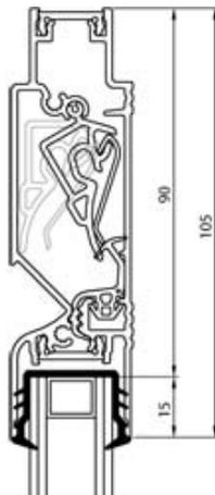
Aérateur à clapet plat à rupture de pont thermique pour application sur vitrage de châssis en aluminium, bois ou PVC. Le clapet interne est réglable dans 5 positions, un clapet supplémentaire auto-réglable classe P3 est intégré afin de garantir une bonne étanchéité à l'eau en position ouverte.
