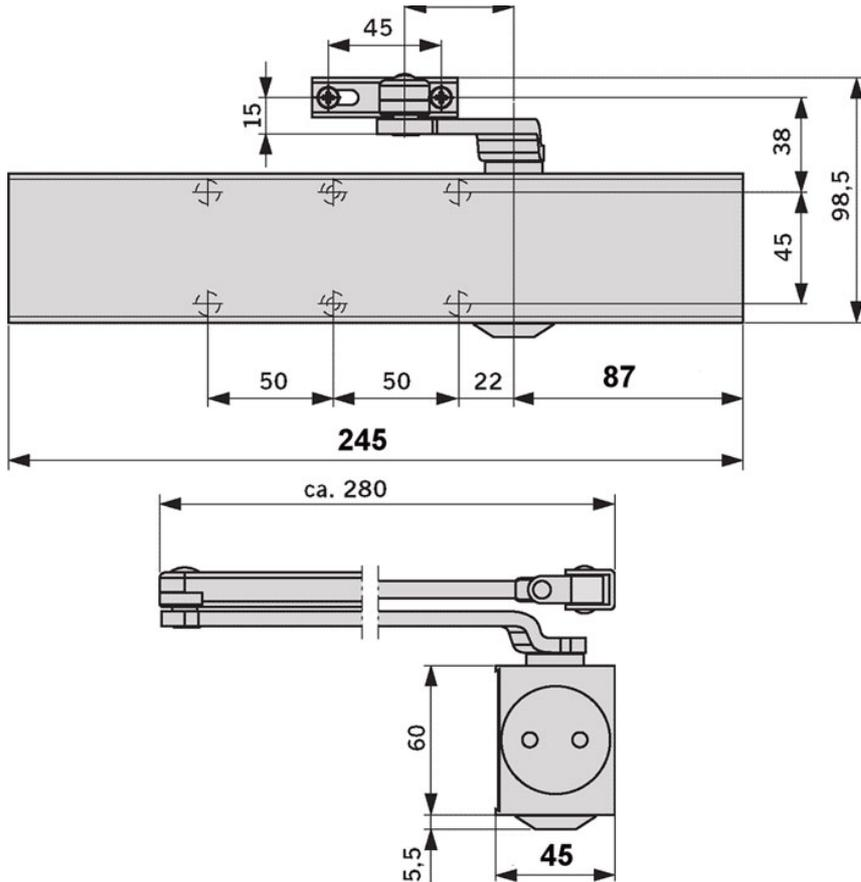
Ferme-porte avec bras plat et retardement à la fermeture TS 83 BC/OD.
