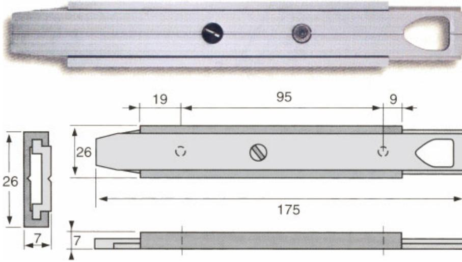
Verrou extra plat à glissière en profil d'aluminium anodisé avec lame de ressort de compression réglable à l'aide d'une vis.
