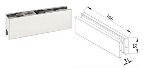
Pour épaisseur de verre de 10 à 12 mm. Pour pivots et pivots hydrauliques avec axe rectangulaire. Utilisable à gauche et à droite.
