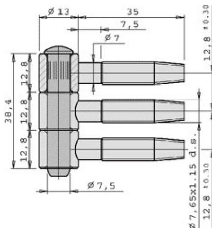
Fiches en acier 3 tiges filetées pour portes et châssis bois.
