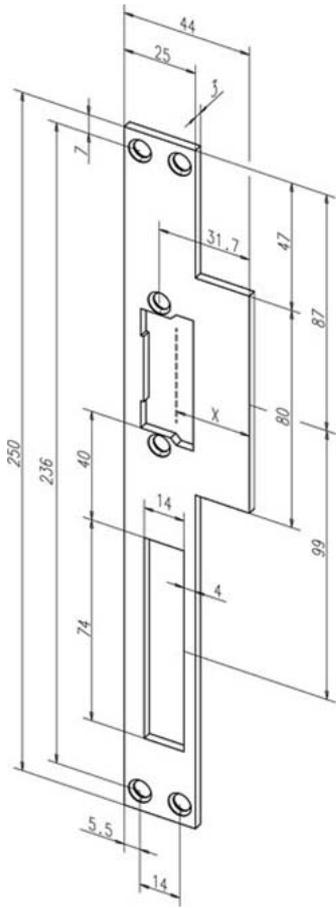
Têtière à languettes et plate avec ouverture pour pêne demi-tour et pêne dormant.
