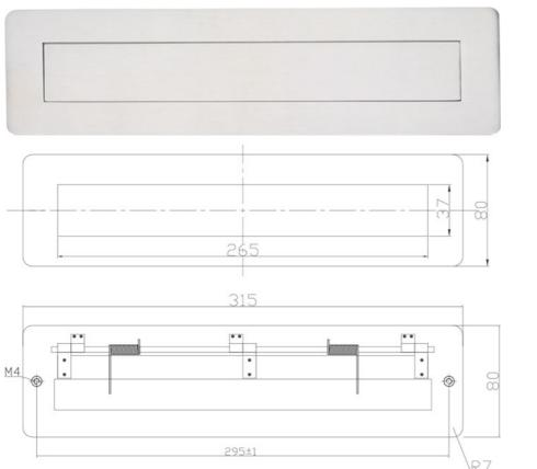
Finition: inox AISI304 satiné mat. Le clapet est maintenu fermé par un ressort. Épaisseur de la plaque : 2 mm. Fixation traversant par 2 vis M4.
