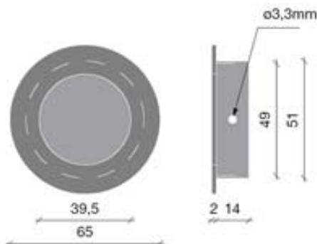
Cuvettes en tôle d'inox AISI 304 d'épaisseur 2 mm.
