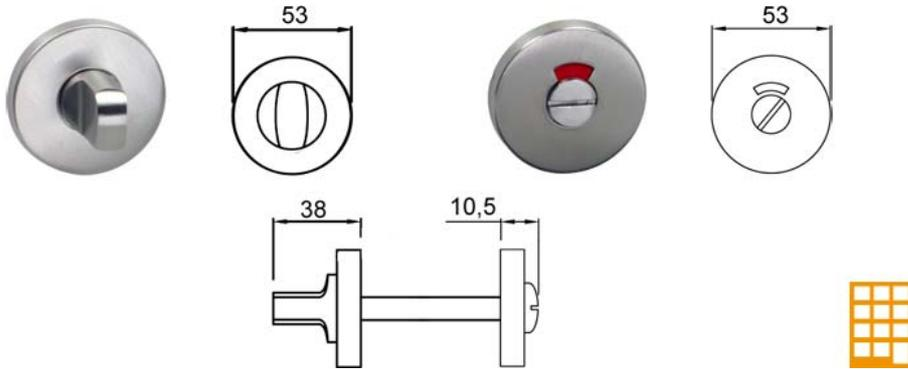
Garniture composée d'embases en acier inoxydable de 1,2 mm d'épaisseur avec coiffes de rosaces en acier inoxydable brossé AISI 304 (18% de chrome et 8% de nickel), de 53 mm de diamètre et de 8 mm de hauteur.
