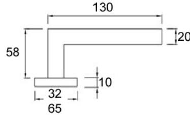
Béquille en tube creux en inox AISI 304 Ø 20 mm.
