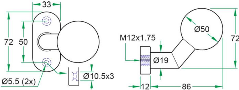
Bouton boule Ø 50 mm déporté, fixe, monté sur embase de 33 x 72 x 12 mm avec entraxe des vis à 50 mm.
