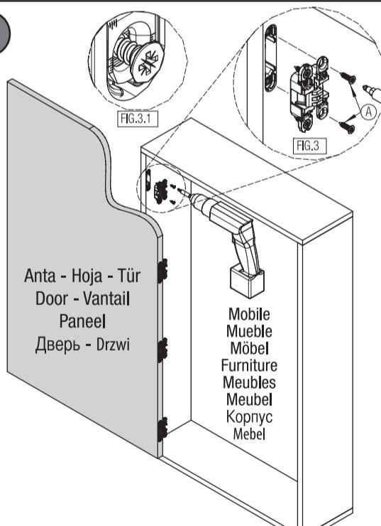
\*Montare l'anta sul mobile. Non serrare completamente le viti "A" (Fig. 3-3.1).
