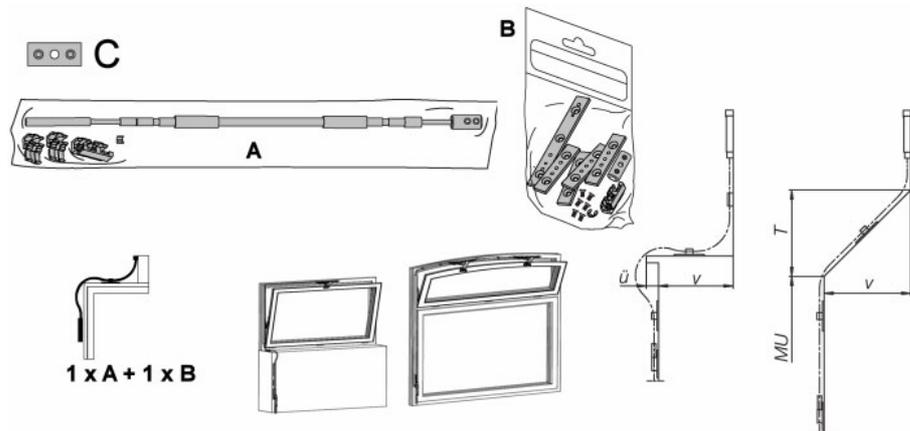
La commande par flexible est utilisée sur les châssis cintrés ou droits avec un ou deux compas ou lorsque le châssis ne se trouve pas sur le même plan que la commande. Son fonctionnement est particulièrement aisé. Livrable dans différents coloris (recouvrement en plastique.)
