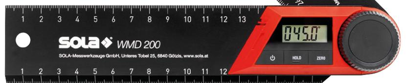
Le rapporteur numérique WMD 200 ou WMD 500 réunit les fonctions d'un rapporteur numérique et d'une règle en un seul outil électronique. Le WMD permet de mesurer, de reporter et de dessiner des angles intérieurs et extérieurs. L'affichage numérique LCD facilite considérablement la lecture de la valeur mesurée et garantit des résultats précis avec une exactitude de  $\pm 0,3^\circ$ .
