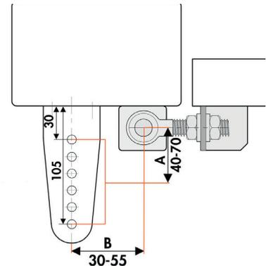
**Position de paumelles 3 :** Montage du DIREKT 150 sur portes avec paumelles à boulons à œillet
