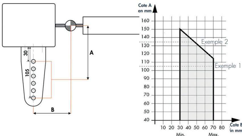
Exemple 1 : Si cote A est 105, cote B peut être 30 à 70 mm
