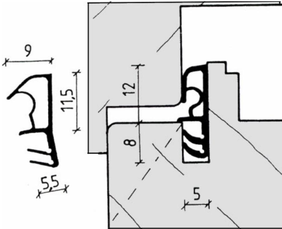
Le joint à chambre d'étanchéité fermée d'une largeur de 9 mm, offre une capacité de tolérance plus importante.
