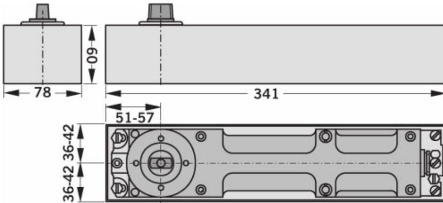
Porte coupe-feu pourvue d'un pivot de sol hydraulique thermoconstant pour portes d'un poids maximum de 300 kg et d'une largeur maximum de 1400 mm avec dispositif d'arrêt électromagnétique aux dimensions très réduites 341 x 78 x 60 mm.
