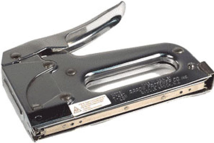
Agrafeuse spéciale pour la fixation des câbles.
