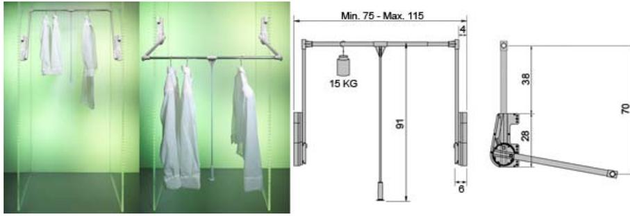
Le profil de la base permet d'éviter toute interférence avec les charnières des portes. Le retour en haut est assuré par un dispositif hydraulique fonctionnant avec un fluide spécial.
