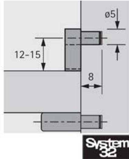
Avec tenon pour diamètre de perçage 5 mm.
