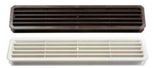
PVC teinté dans la masse. Dimensions hors tout =  $90 \times 450$  mm. Cadre de 10 mm autour de la mortaise. Fixation: en sandwich par 3 vis traversantes livrées.
