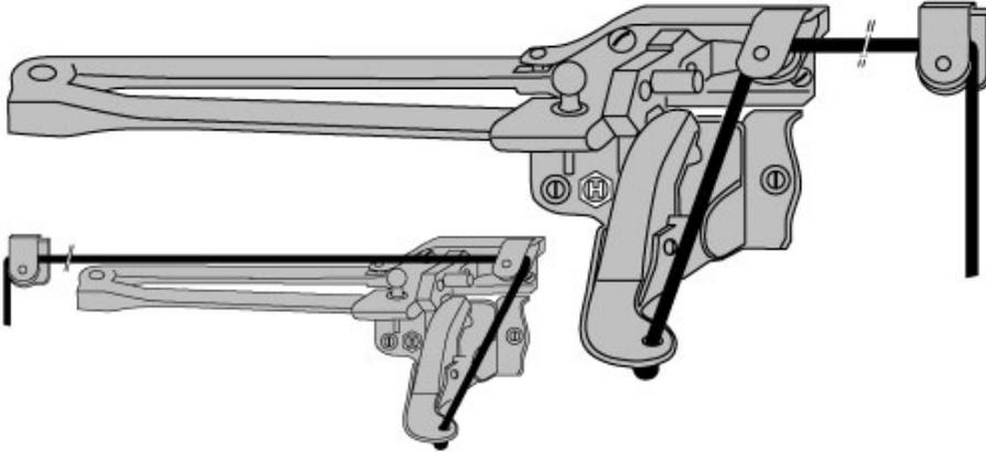
Compas avec ressort et cordelette pour châssis tombant bois ou PVC de faible dimension.
