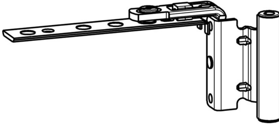
Faux compas M6 : jeu 4 mm, recouvrement 15 mm, axe 9 mm.
