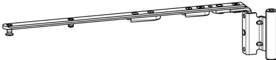
Compas M6 pour jeu de 12 mm, recouvrement 20 mm, axe de 13 mm.
