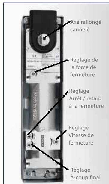
Fig. 06-1 - Pivot de sol GEZE TS 550 NV (dimensions identiques à GEZE TS 550 N EN4)
