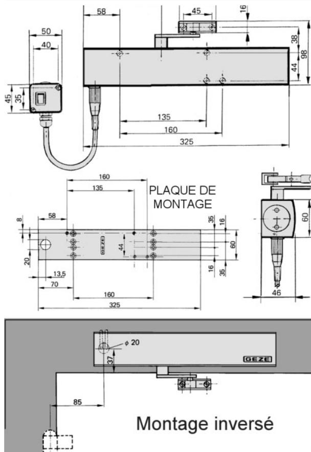
Ferme-porte à pignon et crémaillère elliptique avec arrêt électro-hydraulique intégré, suivant la EN 1155, pour porte simple action. L'arrêt de la porte est progressif entre 80° et 180°.
