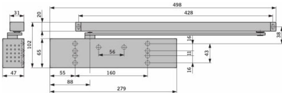
Ferme-porte multifonctionnel à bras à glissière universel à transmission linéaire par came en forme de coeur asymétrique.
