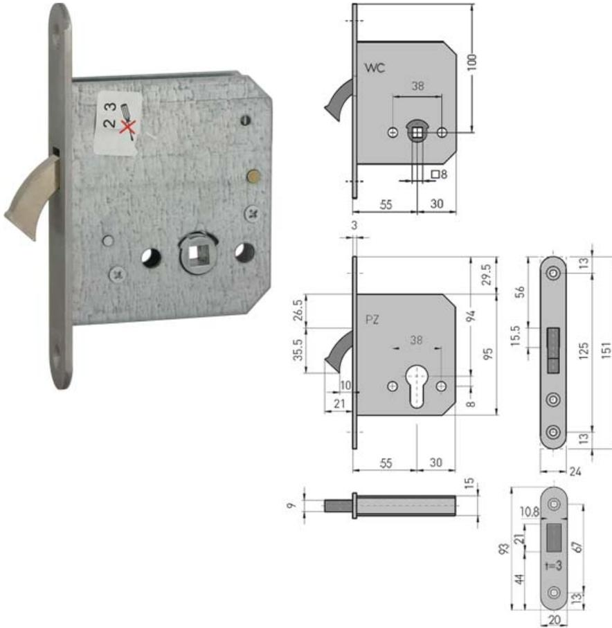
Serrure à entailler pour porte coulissante avec lançant en forme de crochet basculant.
