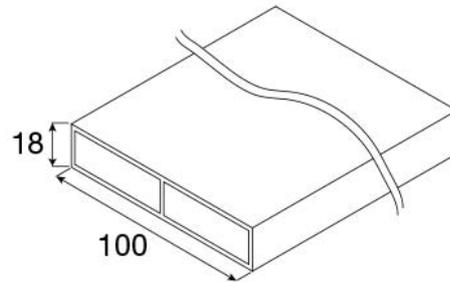
À utiliser avec supports aluminium type 171 (FG 103456).
