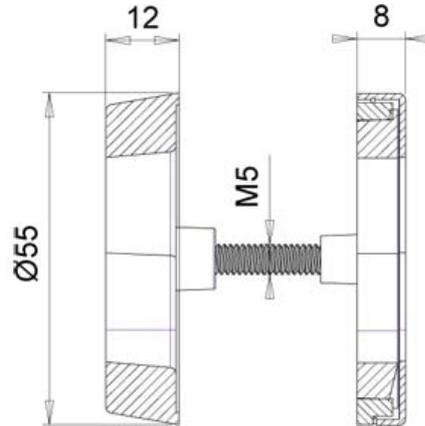
Côté extérieur : aluminium massif anodisé F1 d'épaisseur 12 mm.
