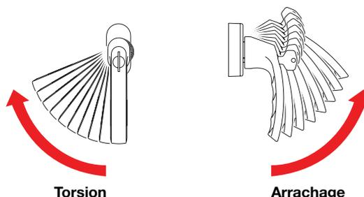
La technique Secustik® rend plus difficiles les effractions par manipulation de la ferrure de fenêtre côté extérieur, grâce à son mécanisme de verrouillage intégré. Le fin crantage audible du mécanisme constitue le signal acoustique pour plus de sécurité pour votre fenêtre.
